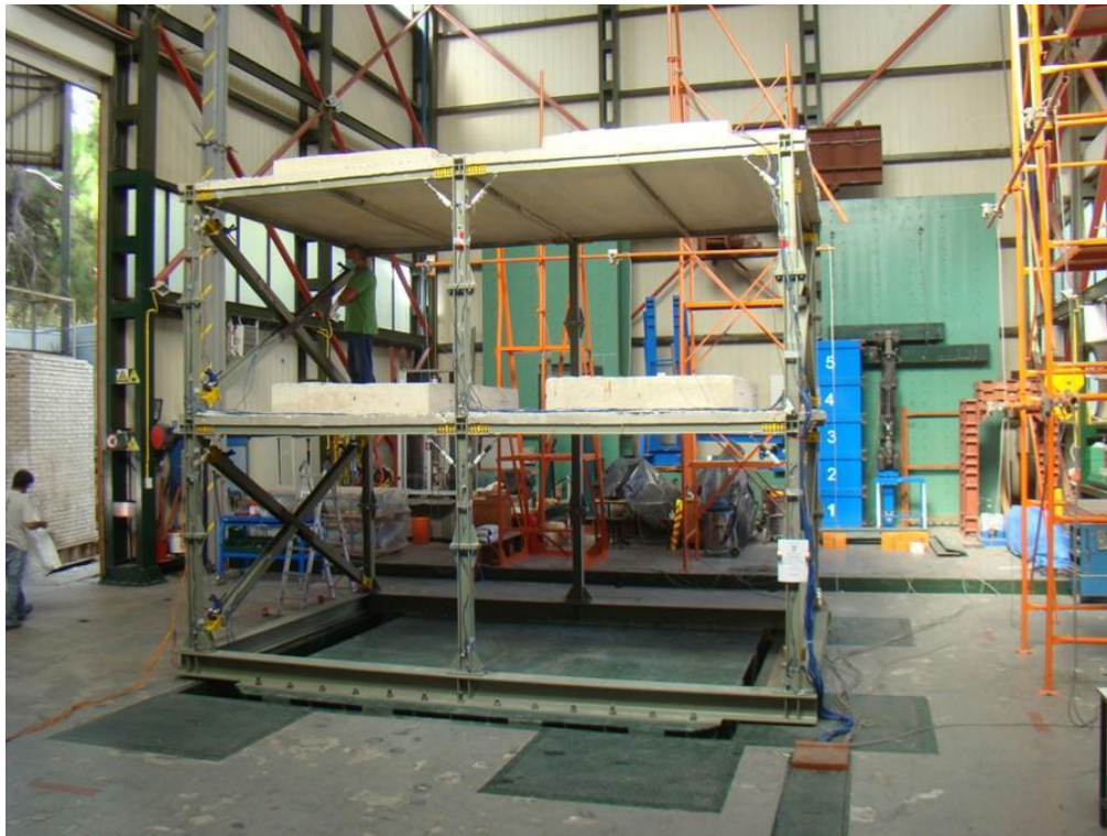
Εργαστήριο Αντισεισμικής Τεχνολογίας – Σεισμικός Προσομοιωτήρας έμπροσθεν του Τοίχου Αντιδρασης
